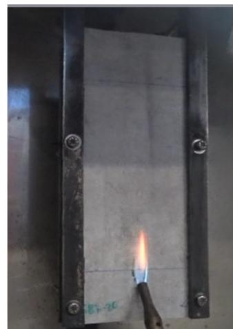
Fotografia 6 – Chama não atinge a marca de 150 mm.
