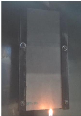
Fotografia 3 – Ensaio com o queimador aplicado na borda do corpo de prova.
