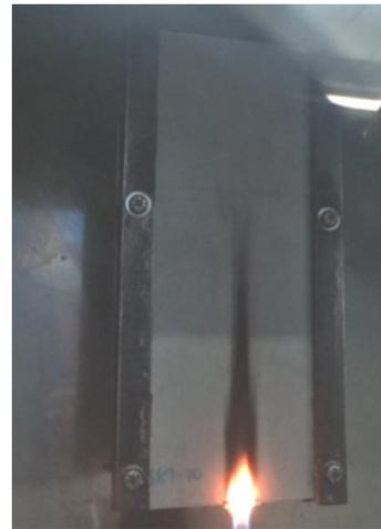
Fotografia 4 – Chama não atinge a marca de 150 mm.
