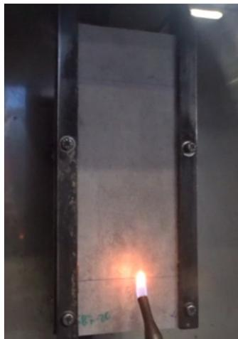
Fotografia 5 – Ensaio com o queimador aplicado na superfície do corpo de prova.
