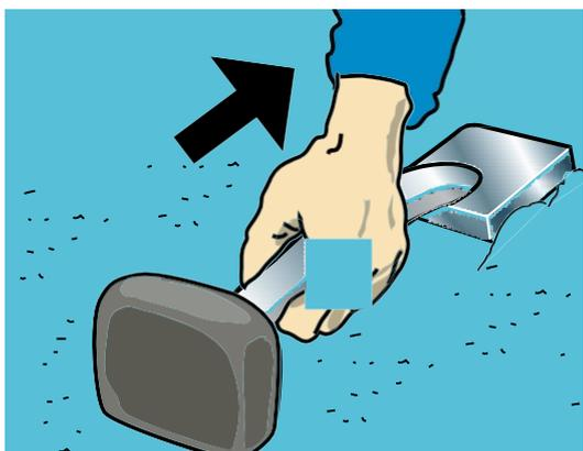
Para garantizar un buen ajuste a los rodapiés, realice el corte utilizando los métodos que se muestran en el diagrama y coloque el borde cortado contra el rodapié. **Al calcular el punto de inicio de la instalación, verifique que las lamas/losetas puedan instalarse sin necesidad de cortes estrechos, mínimo 10 cm. Por lo tanto, puede ser necesario ajustar el punto de partida.**
