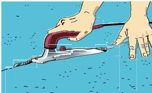
Verifique el ajuste de temperatura del soldador y comience por el principio de cada sección. Los bordes de la moqueta deben caer a ambos lados del soldador de costura con la empuñadura emergiendo entre ellos. Deslizar lentamente el soldador hacia adelante y presione la moqueta sobre el adhesivo con la palma de la mano, el revés de la moqueta debe quedar perfectamente adherido.
